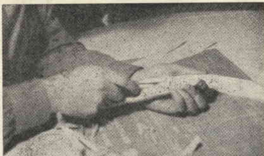
ULTIMATA LA MODELLATURA i due pezzi che compongono lo scafo sono separati per scavare il vano interno destinato al motore.
